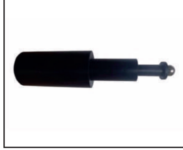
IP2X Test Probu (2 No.lu Deney Sondası, TS EN 61032 Şekil 6)
