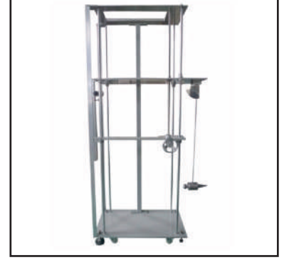
Sarkaçlı Darbe Çekici Cihazı (IK kodları için)
