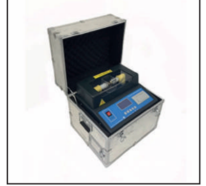
80 kV Taşınabilir Yağ Delinme Test Cihazı
