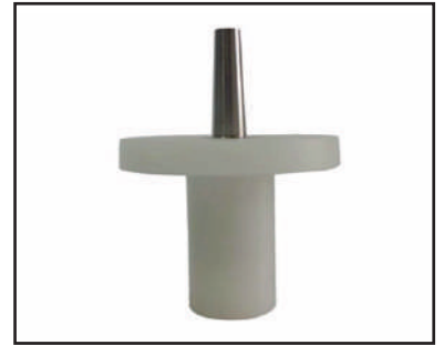
13 No.lu Deney Sondası (TS EN 61032 Şekil 9)
