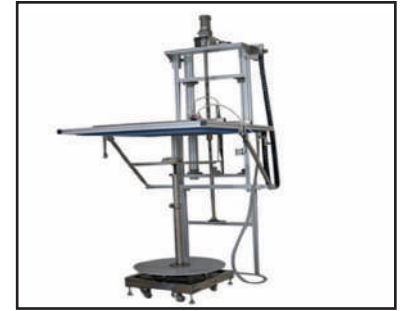
IPX1 ve IPX2 Yağmurlama Test Cihazı (Duvara Montajlı)
