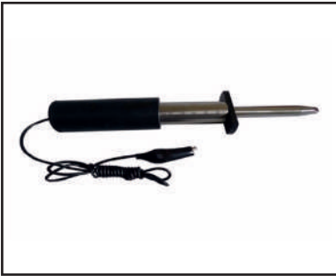
11 No.lu Deney Sondası (Rijit Deney Parmağı, TS EN 61032 Şekil 7)
