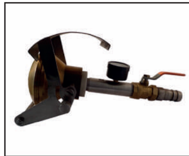
IPX3 ve IPX4 Püskürtme Nozülü (Elde taşınabilir)
