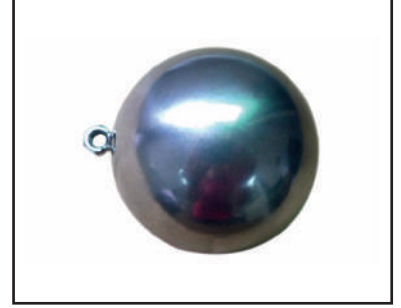
1 No.lu Deney Sondası (TS EN 61032 Şekil 5)
