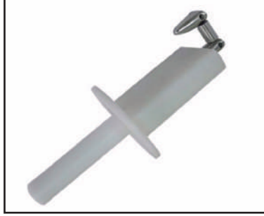
Standart Test Parmağı (B Deney Sondası, TS EN 61032)
