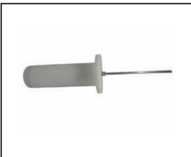
14 No.lu Deney Sondası (TS EN 61032 Şekil 10)
