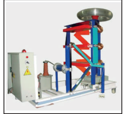
Yıldırım Darbe Gerilimi Test Sistemi
